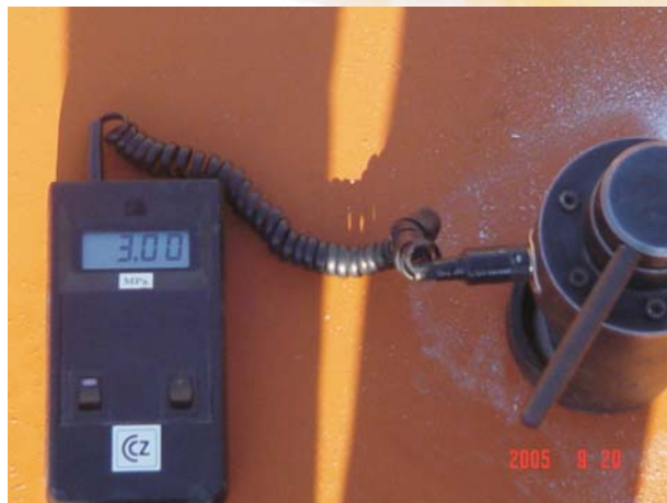
Zkouška přilnavosti systému ELIMINATOR®
